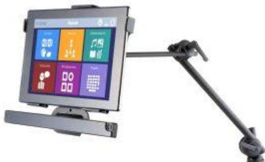
El Irisbond es un sistema que nos permite comunicarnos mediante el control del ordenador con la mirada. Conforme avanza la ELA, este aparato es un aliado esencial para las personas porque nos proporciona el control de nuestras vidas y nos abre las ventanas al mundo a través de internet y todas las posibilidades implícitas.
